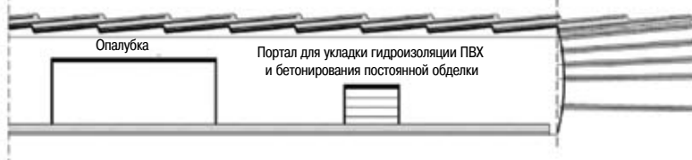
ЭТАП 8. Укладка гидроизоляции ПВХ и бетонирование постоянной обделки
