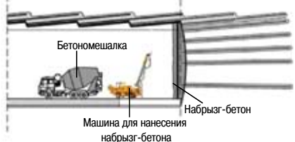
ЭТАП 8. Укладка гидроизоляции ПВХ и бетонирование постоянной обделки
